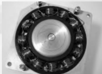
Elektromotor mit Magnetrotor auf Buchse mit Stahlachse
