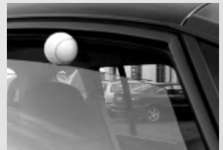
Einklemmschutz bei elektrischem Fensterheber durch Magnetrotor
